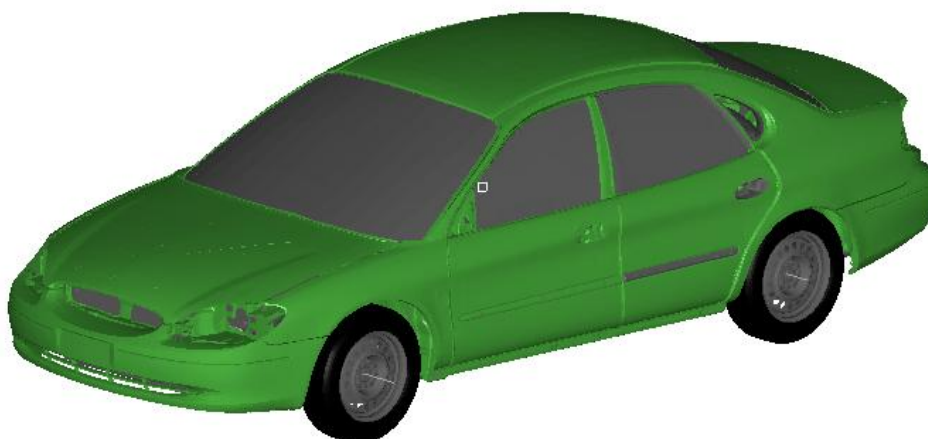
Figura 18 - Modelo em elementos finitos utilizado nos estudos (NCAC, 2008)
