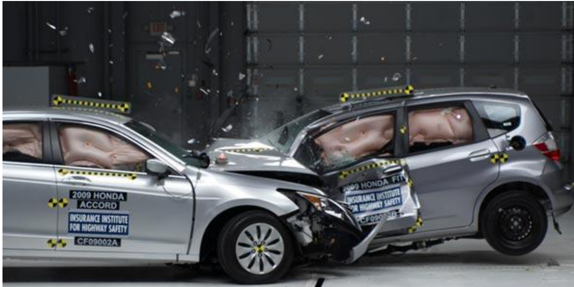
Figura 5 - Impacto entre dois veículos Honda Accord e Honda Fit (IIHS, 2009)
